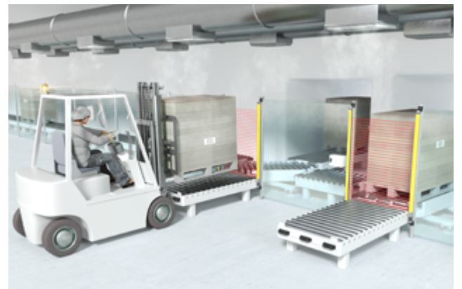
图 2: 即使在 -30^{\circ}\text{C} 的冷冻区, SPG 也可以对物料闸进行极为紧凑的系统布置
